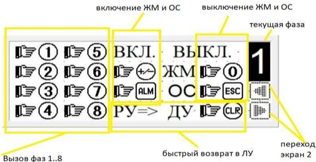
Экран 2 предназначен для ввода уставок длительности фаз 1..8 и максимальной длительности времени фазы в РУ, по истечении которого контроллер вернется в режим ЛУ. С экрана №2 возможен переход на экран пароля (при наличии, по требованию).
